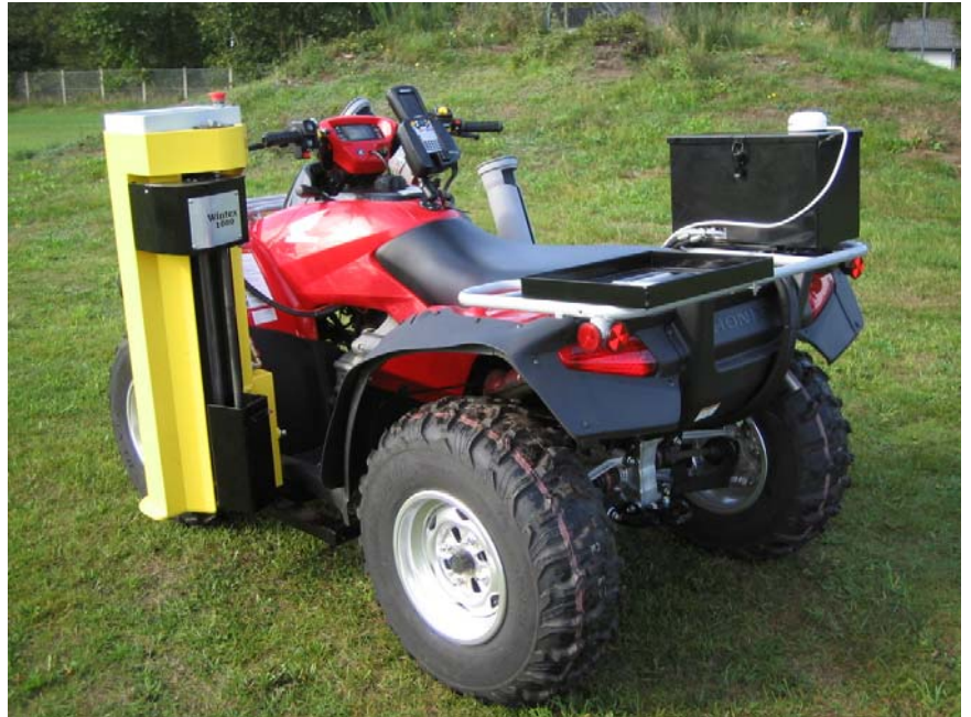
Wintex 1000 montado en un quad de cuatro ruedas, que garantiza una mínima compactación del suelo.
